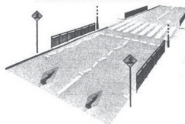
Paso Cebra en Tramo de vía
